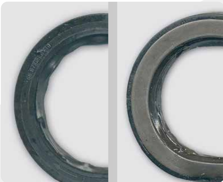
▲ Beschädigte PTFE-Dichtlippe als Ausfallursache.
