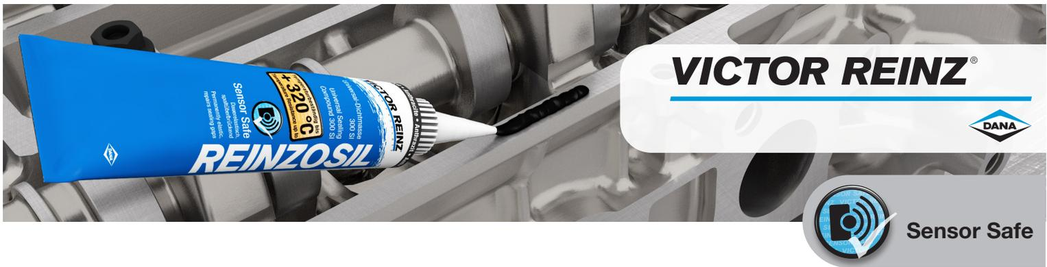
La temperatura de procesamiento está entre + 5 °C y + 40 °C. La formación de la piel comienza después de 2 a 15 minutos, dependiendo de la temperatura y la humedad. El tiempo de curado es fuertemente dependiente de la humedad relativa (HR) y de la temperatura, así como de la anchura de aplicación (anchura de la junta) y del espesor (altura de hendidura).
