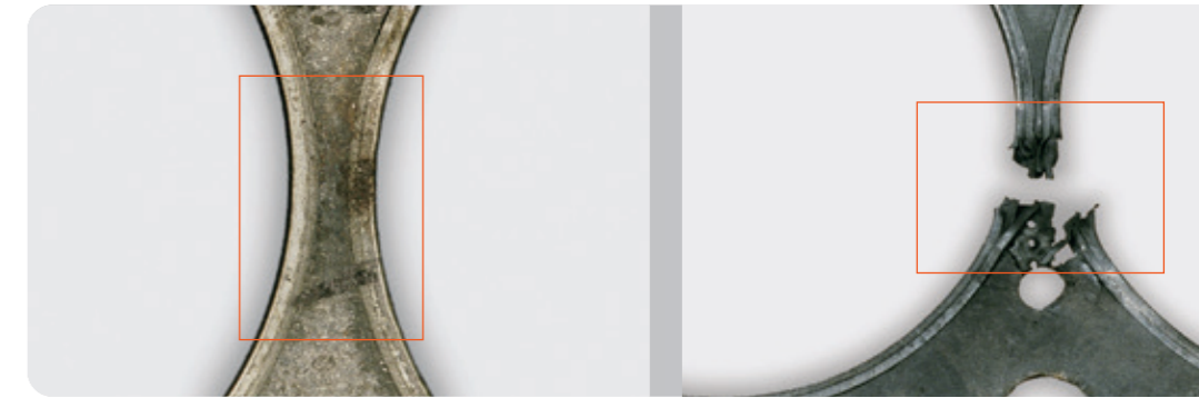
Gasleckage mit lokaler Schwarzfärbung der Brennraumeinfassung.
