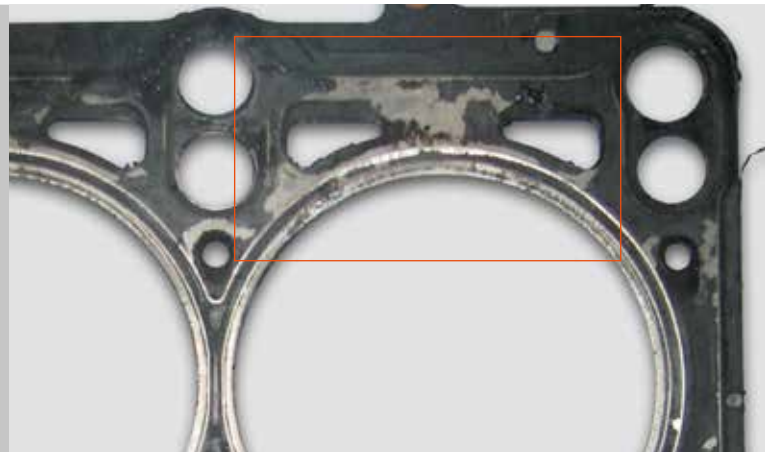
▲ Durch Überhitzung beschädigte Elastomerbeschichtung
