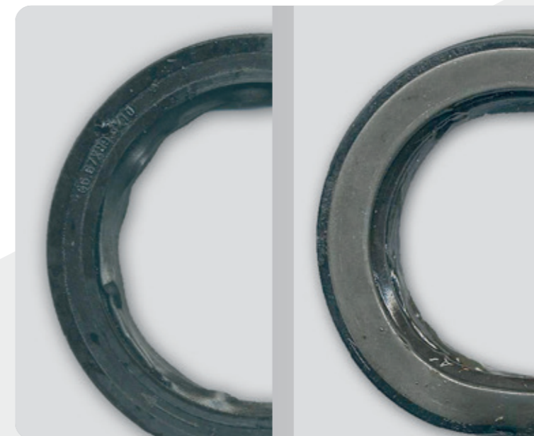
▲ Beschädigte PTFE-Dichtlippe als Ausfallursache.
