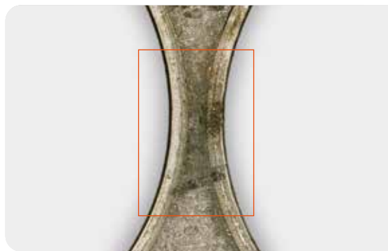
▲ Gasleckage mit lokaler Schwarzfärbung der Brennraumeinfassung.
