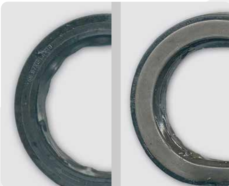
▲ Beschädigte PTFE-Dichtlippe als Ausfallursache.
