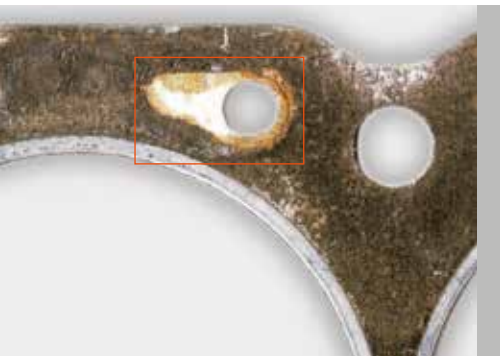
▲ Aufquellungen bei Weichstoff-Zylinderkopfdichtungen durch Überhitzung mit Dampfbildung.
