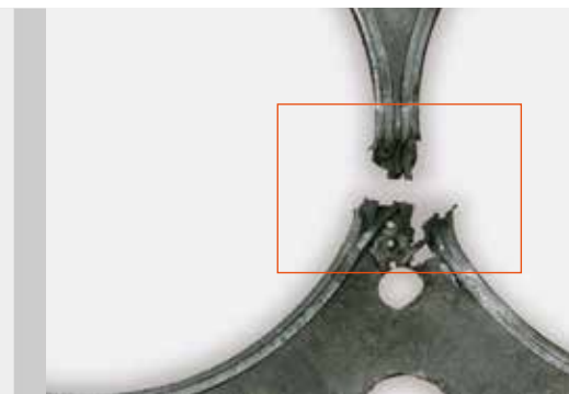
▲ Zerstörungen im Stegbereich durch Überblasen von Brenngasen.
