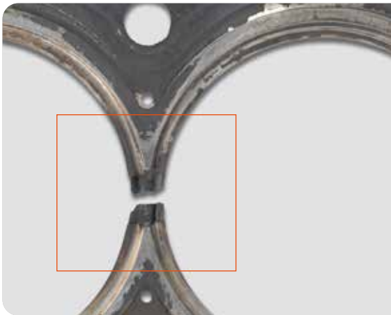
▲ Gebrochener Steg verursacht durch hohe Bauteildynamik
