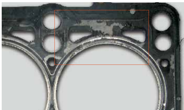
▲ Rivestimento elastomerico danneggiato da surriscaldamento
