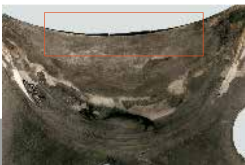
▲ Guarnizione danneggiata nella precamera ad alta turbolenza tipo Ricardo a causa del distacco della camera di combustione a turbolenza. Lamiera distanziatrice rotta in due punti e premuta fuori.
