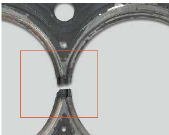
▲ Settore rotto a causa di una dinamicità troppo elevata degli elementi strutturali
