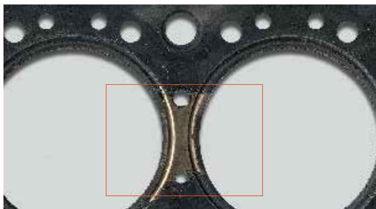
▲ Rivestimento elastomerico bruciato
